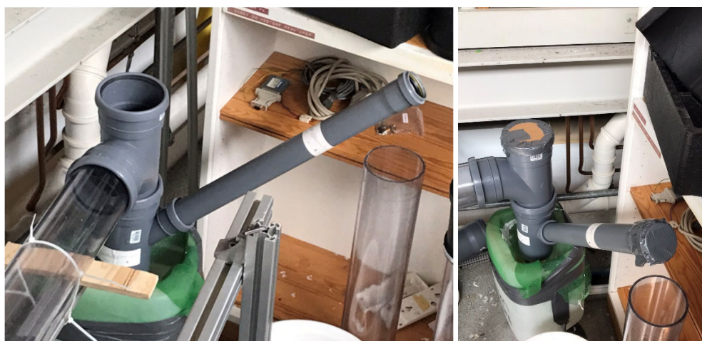
Figur 10: Emulering av begränsning av luftning.
