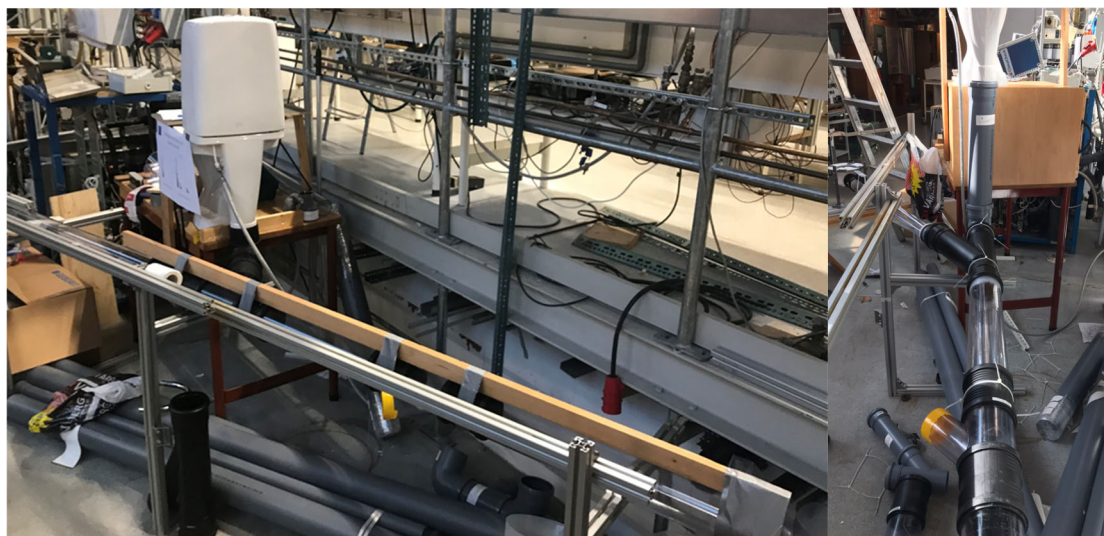
Figur 3: Experimentell uppställning för tester av återspolning i duschspillvattenledning.
